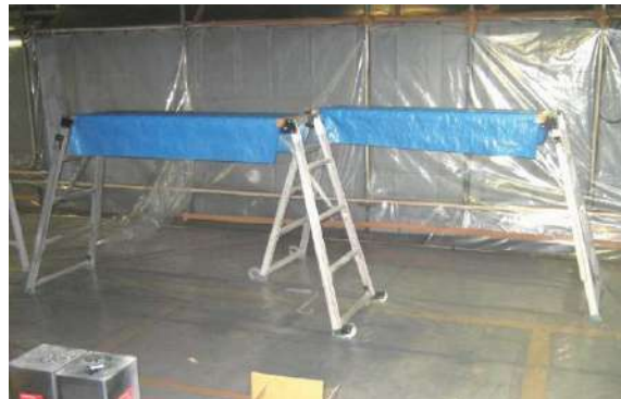
図 4.7.57 可搬式作業台の例
