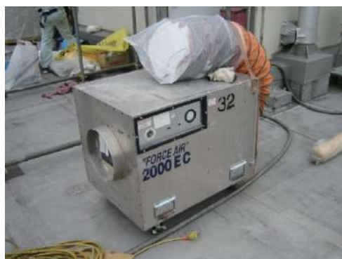
図 4.7.35 集じん・排気装置の例
