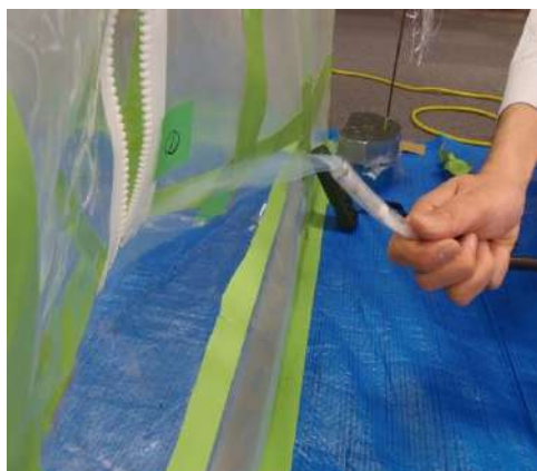
図 4.14.10 スモークテスターによる確認
